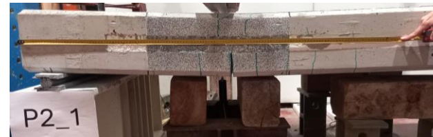
P2 – Trelças metálicas 3D
